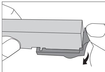
2. インクカートリッジのラベル色とプリンターの挿入箇所の色を合わせ、セットしてください。
