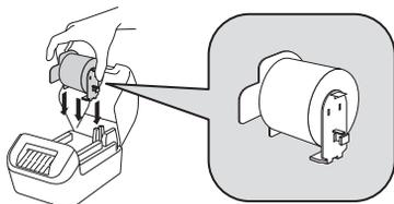
3. ラベルロール紙の先端をラベル出カスロットの内部へ差し込みます。
