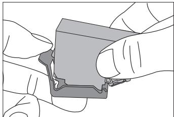
2、インクカートリッジのラベル色とプリンタの挿入箇所の色を合わせ、セットしてください。
